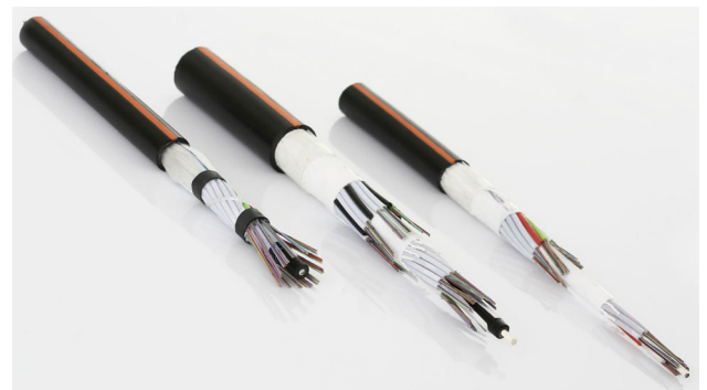
“FO Outdoor” buitenkabels van Datwyler zijn door de combinatie van de HDPE-mantel, bronelementen en met gel gevulde aders “quasi dwarswaterdicht”.
