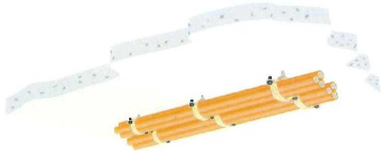
Tragsystem: Einzelschelle mit Dübel
